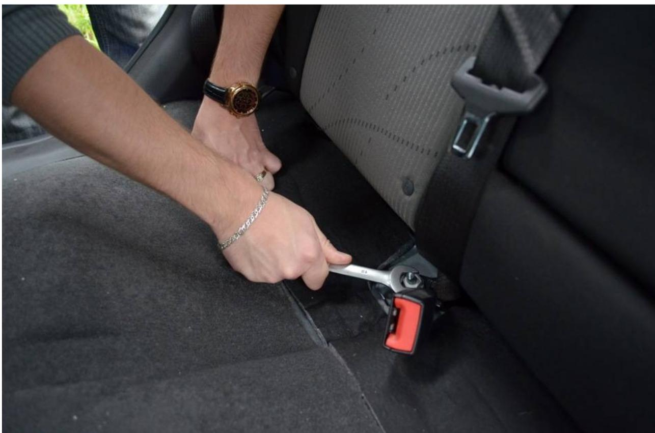
Что бы снять задний диван нам необходимо забраться в машину встать спиной к лобовому стеклу и взяться краем что ближе к полу задний диван и резко с усилием его дернуть, он должен выйти из фиксаторов! Далее аккуратно толкаем (внимание его держат накидные петли\*) его от себя и он оказывается у нас в руках! Далее все просто натягиваем чехол и пропускаем шнурок через специальные ушки зиг-загом, как показано на инструкции рисунке в комплекте с чехлами и надежно связываем это дело узлами))
